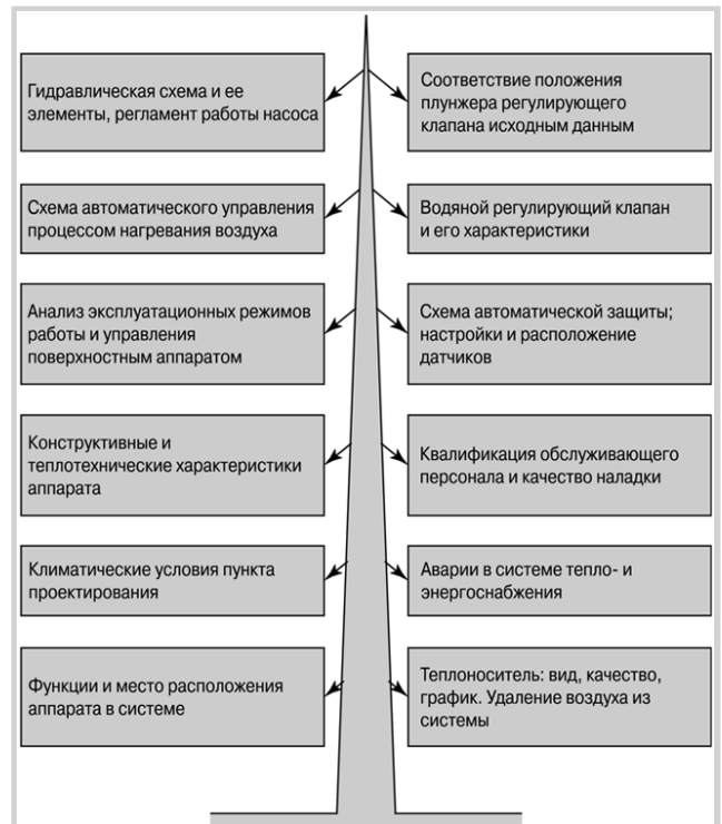
Рис. 3. Условное дерево ошибок для анализа причин замерзания воды в трубах.
