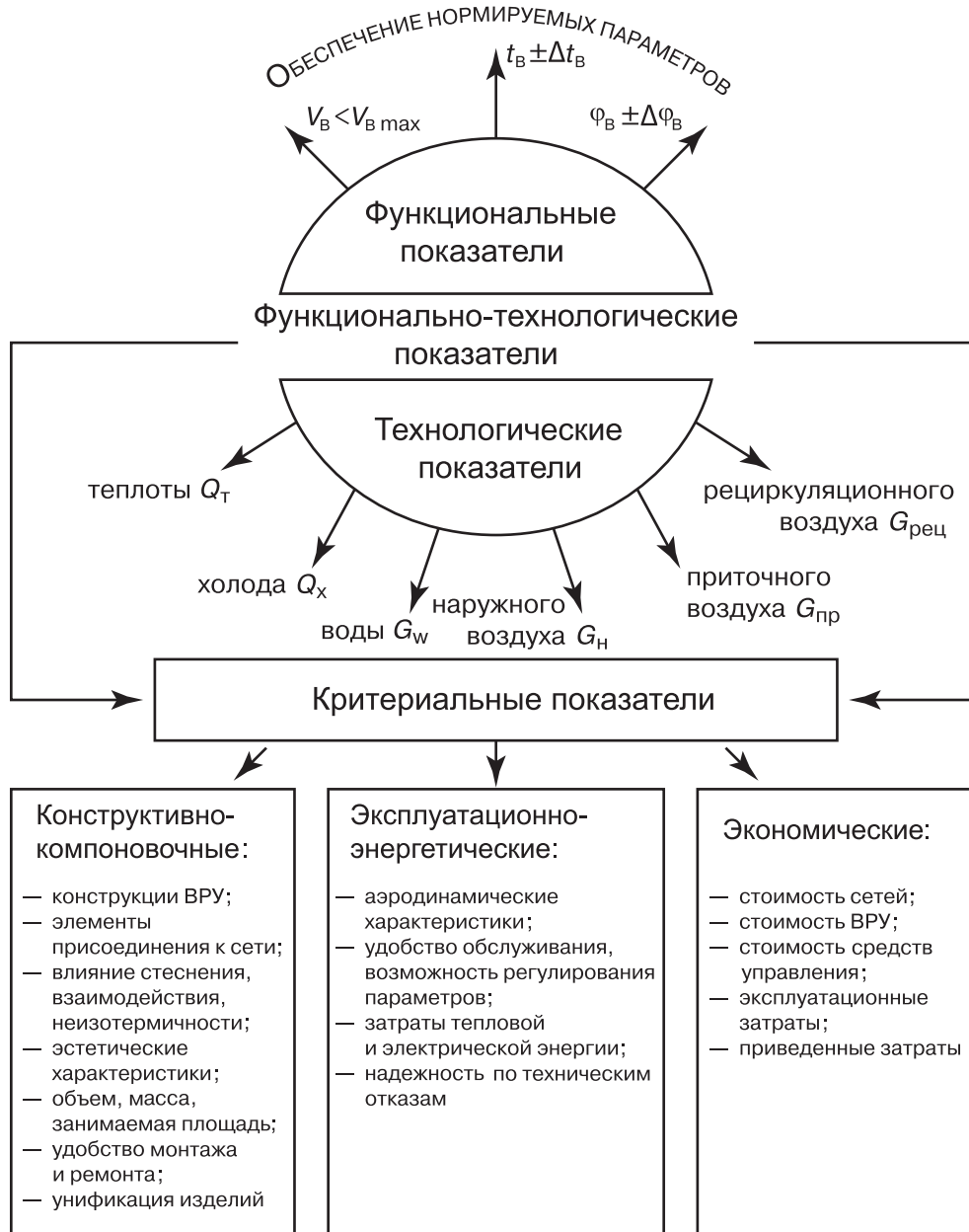
Рис. 11. Схема, объясняющая содержание и взаимосвязь технико-экономических показателей для системного анализа способов и средств воздухораспределения
